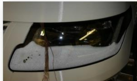
Obrázek 4: Kondenzace světloometu – porovnání analýzy s fyzickým testem
