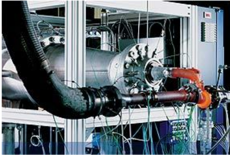
Obr. 4 Testování turba na plynovém hořáku
